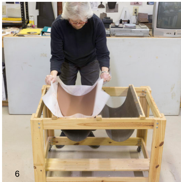
6. Platen worden met een ondersteunende doek op het dakleer gelegd...
