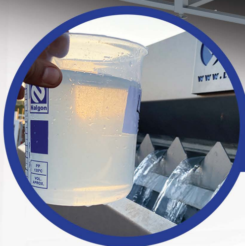
Descarga do efluente clarificado
